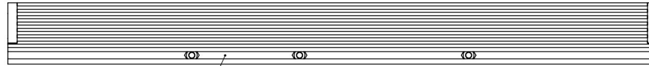
M3安装螺母滑槽，可根据安装需求调节安装
