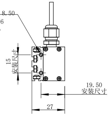
M3安装螺母滑槽，可根据安装需求调节安装
