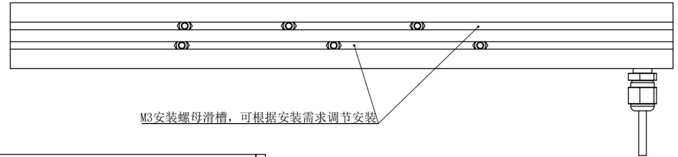
M3安装螺母滑槽，可根据安装需求调节安装
